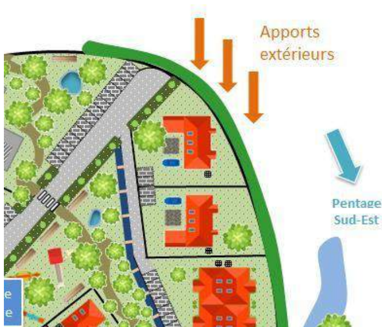
Figure 1 : Déviation des apports d'eau extérieurs par un fossé ouvert
