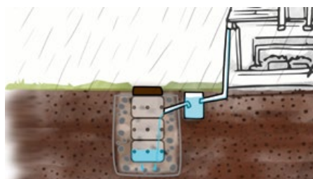
Le puits d'infiltration
