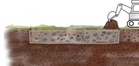
La tranchée drainante
